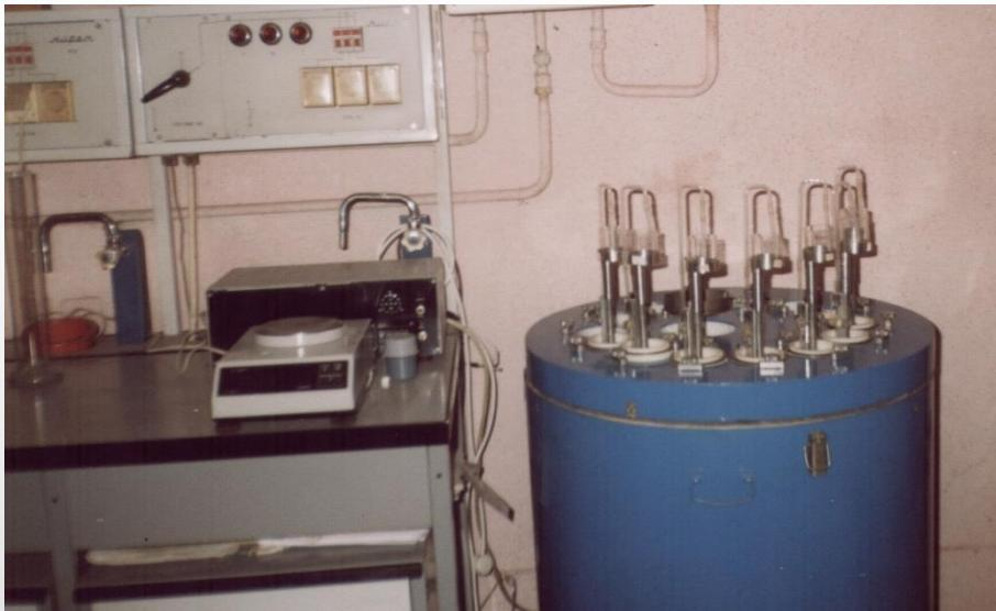
Обладнання для вивчення дихального газообміну рослинних та ґрутових зразків в закритих камерах «Вуглець-Респірометр»
